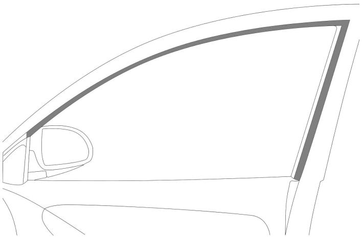
Придав экрану форму проёма окна (см. Этап №1), приложите P-крепление к магниту способом, показанным на рис. ... и прислоните экран к проёму окна. Поставьте отметки в том месте на раме автомобиля, где будет располагаться крепление. Придайте P-креплению форму рамы двери (рис....)
