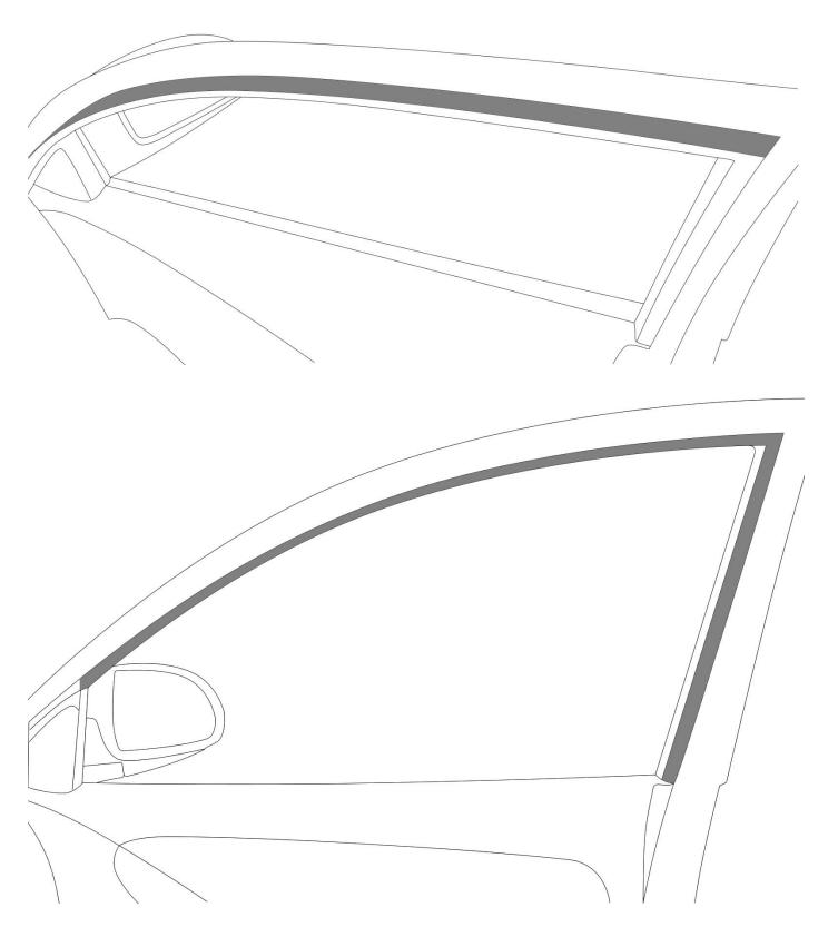
Придав экрану форму проёма окна (см. Этап №1), приложите PSP-крепление к магниту способом, показанным на рис. ... и прислоните экран к проёму окна. Поставьте отметки в том месте на раме автомобиля, где будет располагаться крепление. Придайте PSP-креплению форму рамы двери (рис....)
