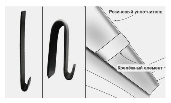
После придания S — креплению нужной формы, прислоните экран в проём окна и выровняйте крепёж относительно магнита, расположенного на каркасе экрана (рис...). Внимательно осмотрите место контакта магнита и крепежа. Магнит должен соприкасаться всей поверхностью с S — креплением. Если же магнит не полностью прилегает к крепежу, то S — крепление следует немного отогнуть от резинового уплотнителя, тем самым улучшив контакт магнита с крепежом (рис...)
