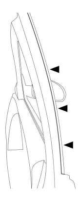
**Внимание!** Крайне важно найти оптимальное расположение экрана в проёме окна. На многих моделях экран необходимо установить заподлицо с контуром дверной рамы изнутри автомобиля, а где-то его следует поставить ближе к стеклу. По контуру экрана, между его каркасом и рамой проёма окна допускается технический зазор (1-3мм), необходимый для установки крепежа и удобного пользования продуктом.
