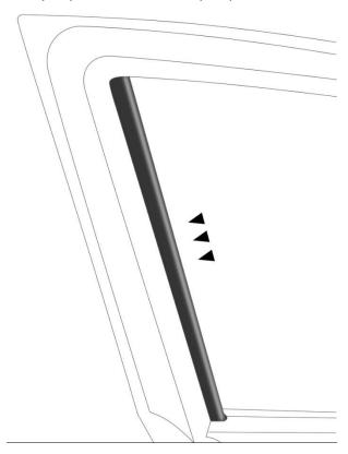
В комплекте к экранам могут идти S — крепления разной длины (от 35 до 70 мм). На некоторых моделях резиновый уплотнитель имеет разную ширину по верху рамы и по вертикальной стороне ремня безопасности, поэтому длина крепежа подбирается согласно ширине резинового уплотнителя.
