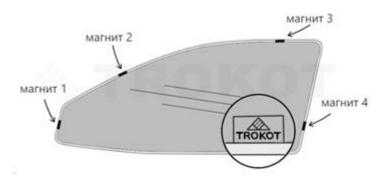
Солнцезащитный экран на **передние** и **задние** двери устанавливается на расстоянии от 1 до 4 см от стекла, внутрь проёма окна или внакладку на дверную раму изнутри автомобиля, и комплектуется крепёжными элементами (подробнее об этом на 2-м этапе установки).
