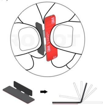
Подобрав индивидуально для каждого L — крепления оптимальный угол разворота, можно приступать к монтажу крепежей на раму проёма окна.
