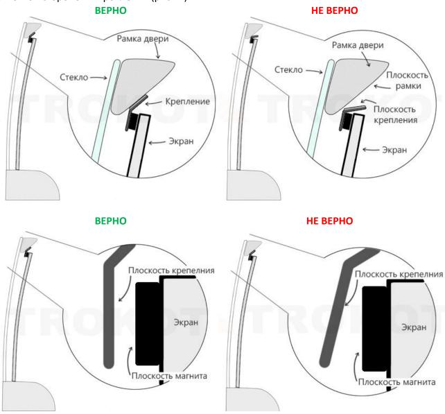
В зависимости от модели Вашего автомобиля, L — крепления для Вашего комплекта экранов подобраны согласно углу наклона обшивки дверной рамы. Для более точной корректировки угол L — крепления можно изменить путём сгибания/разгибания крепежа (для удобства рекомендуется использовать плоскогубцы) (рис...).
