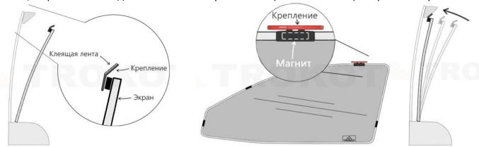
Внимательно рассмотрите, под каким углом располагается L – крепление относительно рамы проёма окна. Сторона L - крепления с клейкой лентой 3M должна всей поверхностью прилегать к раме проёма окна, а так же сам магнит на каркасе экрана должен всей поверхностью прилегать к ответной стороне L – крепления (рис.....).
