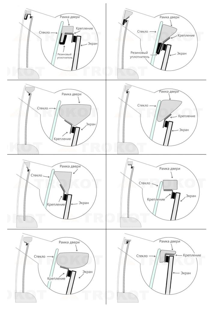
**Не отклеивая** защитную красную плёнку с ленты 3М, прислоните L – крепление к магниту (рис...) и выровняйте крепёж относительно магнита (рис...). Открыв дверь автомобиля и опустив до конца стекло, приложите подготовленный к установке (см. Этап №1) экран в проём окна.
